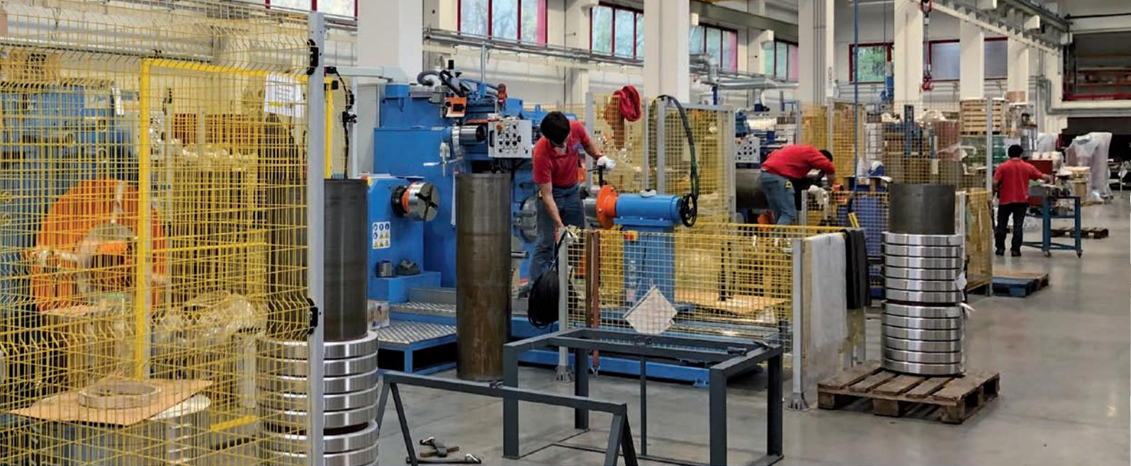
BOBINATRICI DI ULTIMA GENERAZIONE PER LA REALIZZAZIONE DI AVVOLGIMENTI AT/BT
